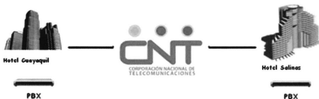
Gráfico 03.- Conexión actual de las centrales telefónicas.
