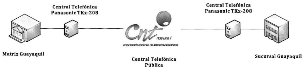
Gráfico 02.- Conexión actual de las centrales telefónicas.
