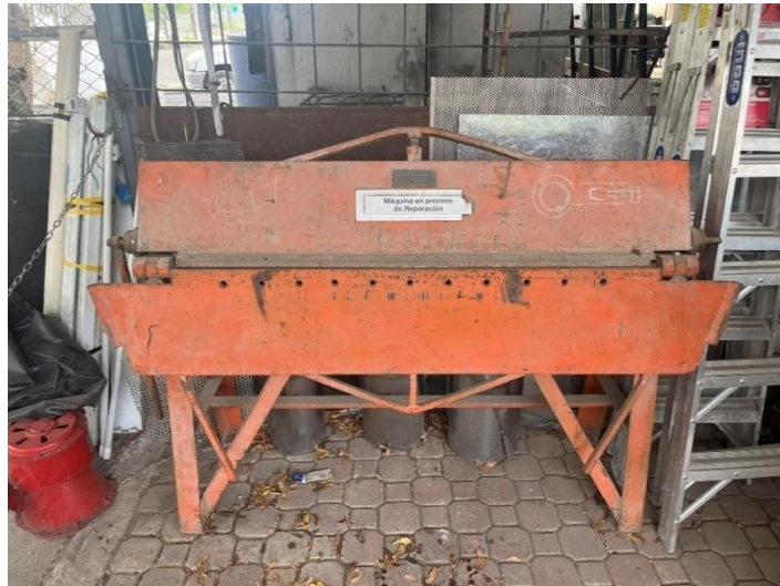
Dobladora Manual de Láminas del CDTS Vista Frontal
