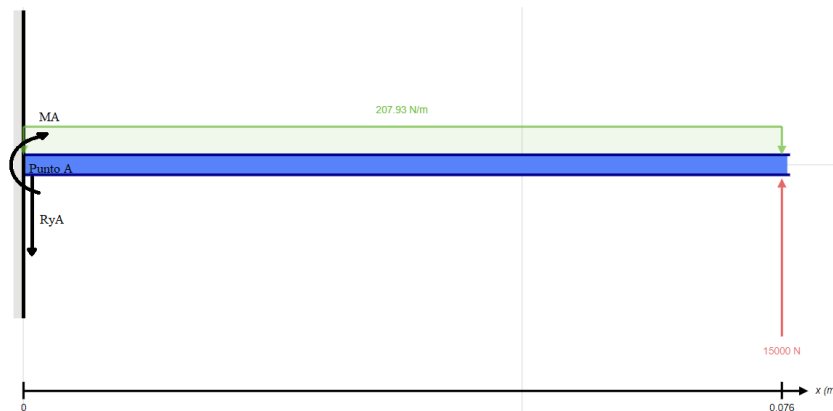
Diagrama de Cuerpo Libre con Reacciones y Fuerzas Involucradas en el Proceso de Doblado
