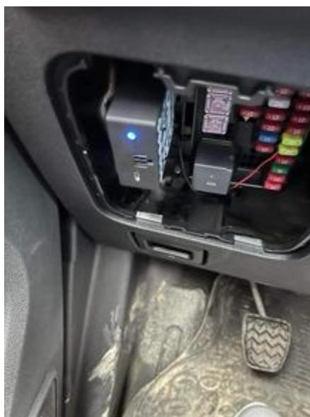
*Figura 23. Conexión de dispositivo Freematics ONE + Model A en vehículo de persecución.*
