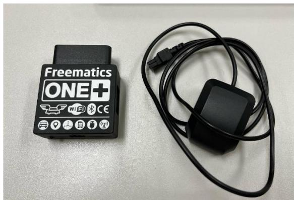
*Figura 22. Dispositivo Freematics ONE + Model A con receptor GPS externo.*
