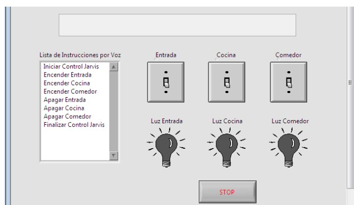
Figura 2.32: Panel Frontal de la Interfaz Gráfica creada en LabVIEW utilizando el DSC Module.
