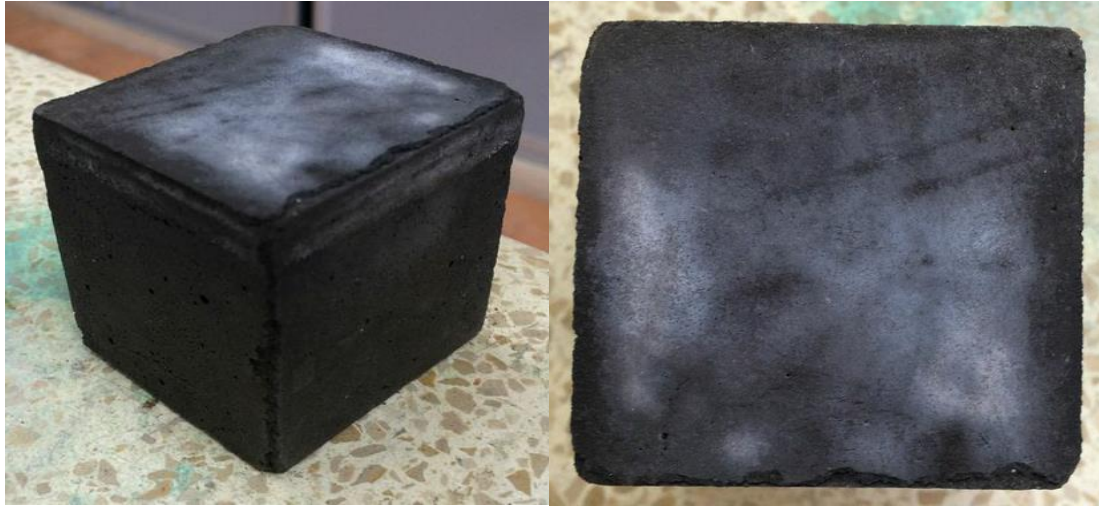
FIGURA A.3 EFLORESCENCIA DE LA MEZCLA 0,2/36/89 NIVEL 4
