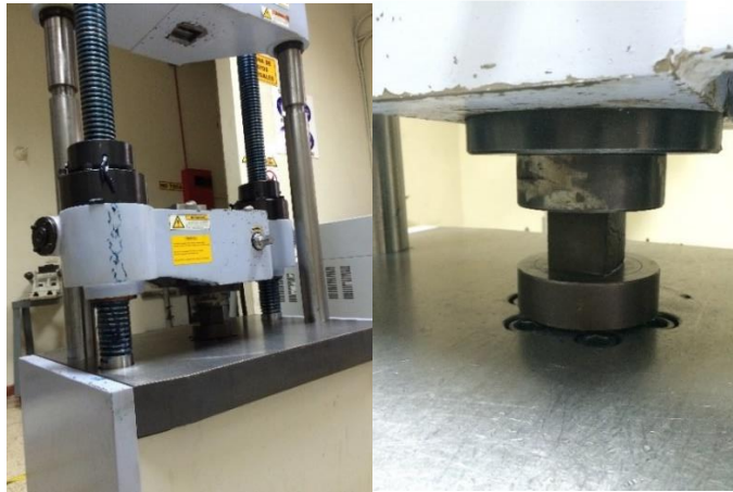
FIGURA 4.34 COLOCACIÓN DEL CUBO PARA EL ENSAYO DE COMPRESIÓN
