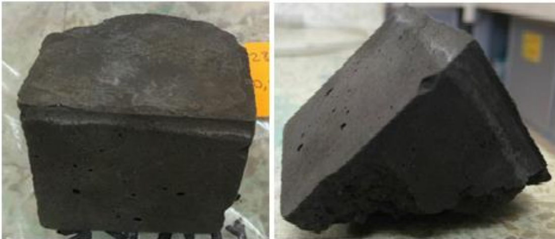
FIGURA A.4 EFLORESCENCIA DE LA MEZCLA 0,2/24/45 NIVEL 3
