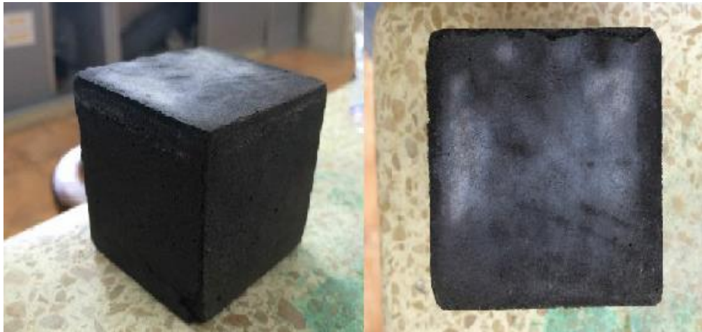
FIGURA 5.13 MUESTRA EL MORTERO DE LA MEZCLA DE 36 HORAS DE CURADO CON 89 MINUTOS DE MOLIENDA Y UNA RELACIÓN AGUA-SÓLIDO DE 0,2 EL CUAL PRESENTA EL MAYOR VALOR DE EFLORESCENCIA DE LOS MORTEROS A LOS 55 DÍAS.
