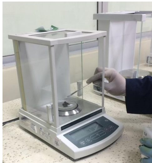
FIGURA 4.4 PESAJE PARA LA PREPARACIÓN DE LA MUESTRA PARA EL ENSAYO DE XRD
