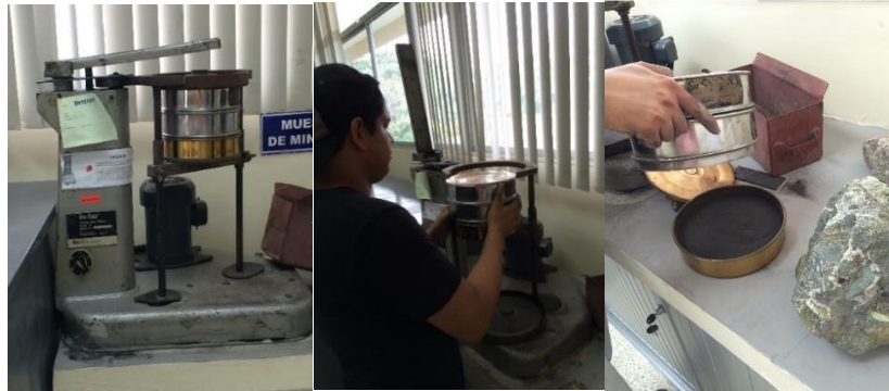
FIGURA 4.24 TAMIZANDO LA ESCORIA MOLIDA CON EL TAMIZ
