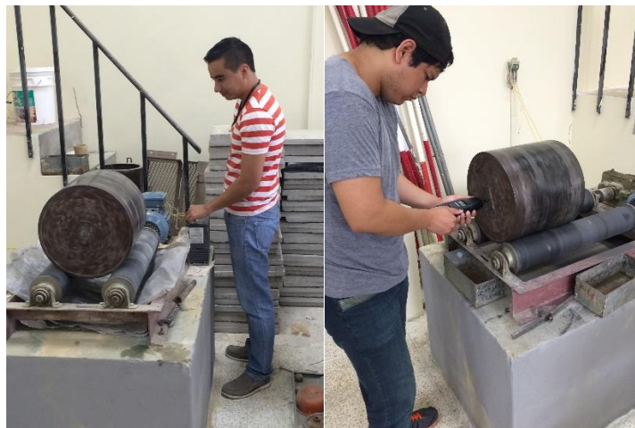
FIGURA 4.28 REGULANDO Y VERIFICANDO LA VELOCIDAD DEL MOLINO DE BOLAS.
