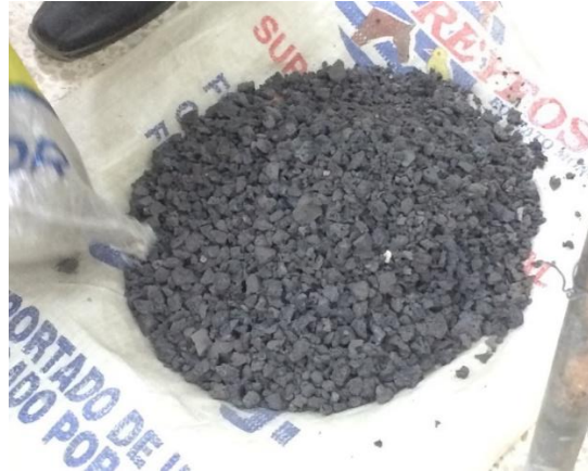
FIGURA 4.21 TAMAÑO DE SALIDA DEL GRANO DE LA TRITURADORA DE MANDÍBULAS.
