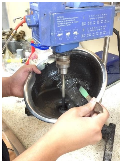
FIGURA 4.31 MEZCLADO DE LA MUESTRA CON LOS ACTIVADORES.
