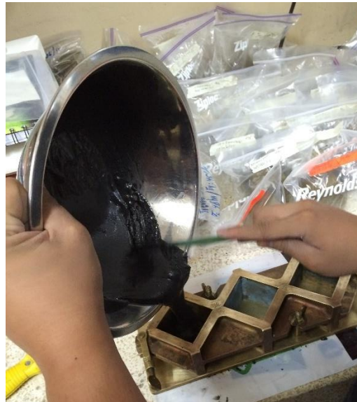
FIGURA 4.32 ECHANDO LA MEZCLA EN LOS MOLDES.
