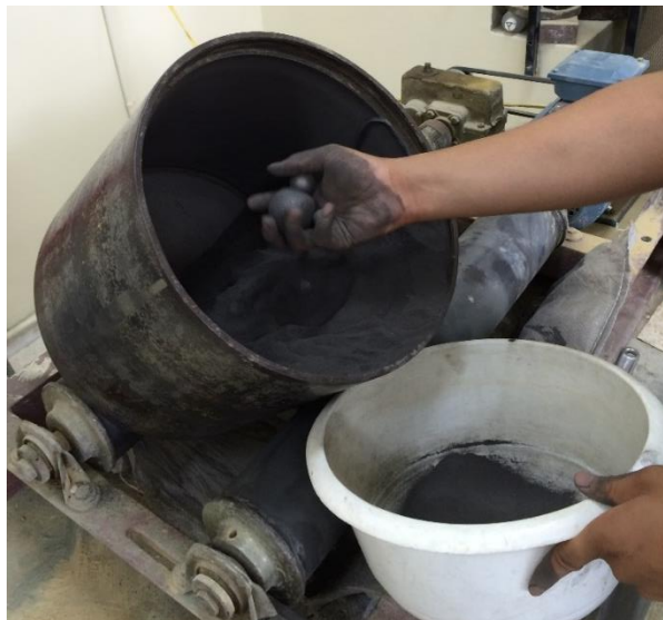
FIGURA 4.23 TAMAÑO EL GRANO DESPUÉS DE HABER MOLIDO DURANTE UNA HORA EN EL MOLINO DE BOLAS.
