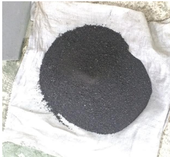
FIGURA 4.22 TAMAÑO DEL GRANO DESPUÉS DE 3 PASADAS POR EL TRITURADOR DE RODILLO
