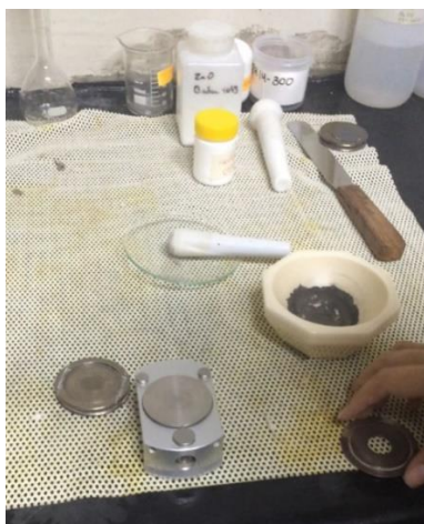
FIGURA 4.5 ACCESORIOS PARA LA PREPARACIÓN DE LA MUESTRA PARA EL ENSAYO DE XRD
