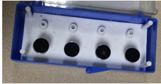
FIGURA 4.7 PORTAMUESTRA DEL SEM: DISCO DE CARBONO
