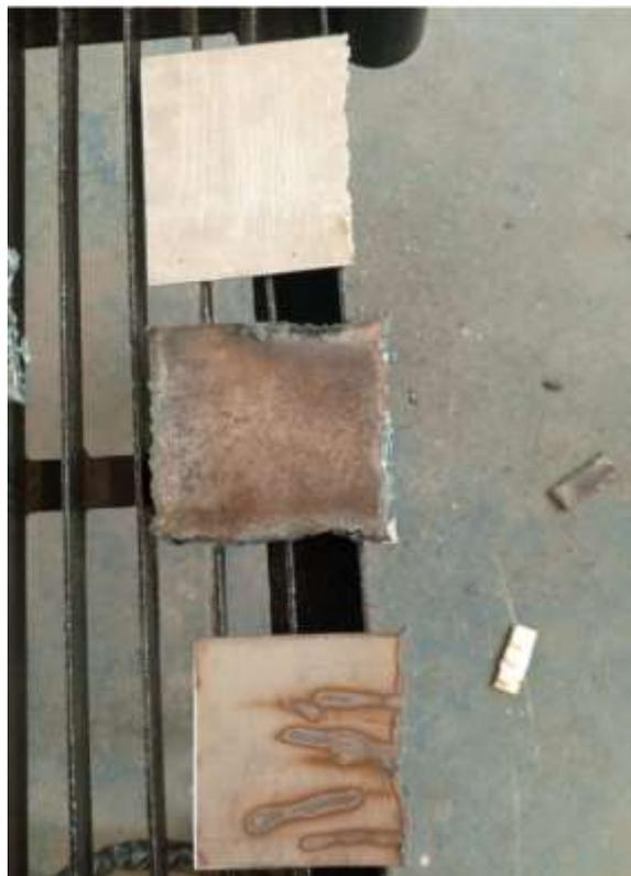
**Nota.** Se realizan pruebas de corte con diferentes materiales como acero inoxidable, aluminio, etc., validando el correcto funcionamiento e instalación de los equipos de corte.
