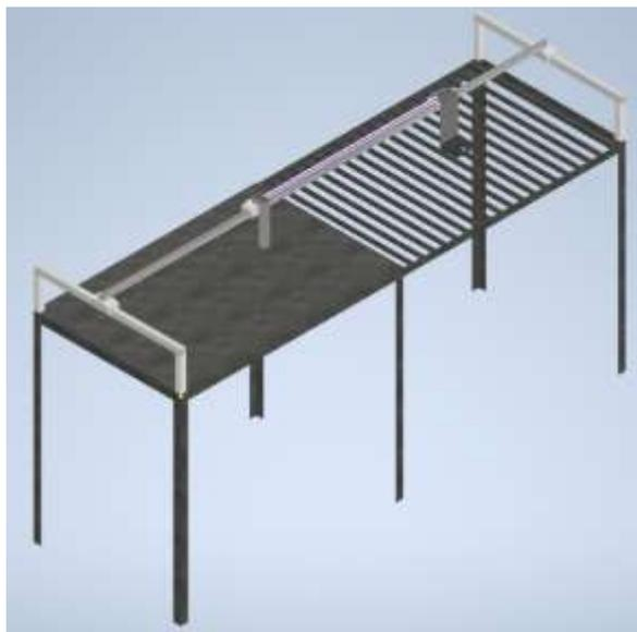
Una vez realizado estos cambios en el diseño se procede a realizar un nuevo prototipo, donde se incorporan los rodamientos lineales HGW 25 CC Z0, para esto es necesario fabricar los carriles mediante torno para garantizar un correcto funcionamiento, no obstante para fines experimentales y reducción de costos se realizan estos carriles de manera artesanal mediante la unión de platinas
