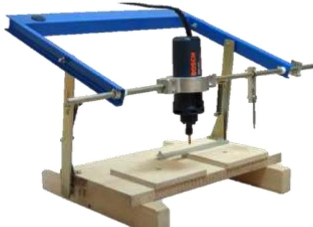
**Nota.** La figura muestra una estructura mecánica manual adaptada a una herramienta de corte, para grabados o cortes de diferentes materiales.
