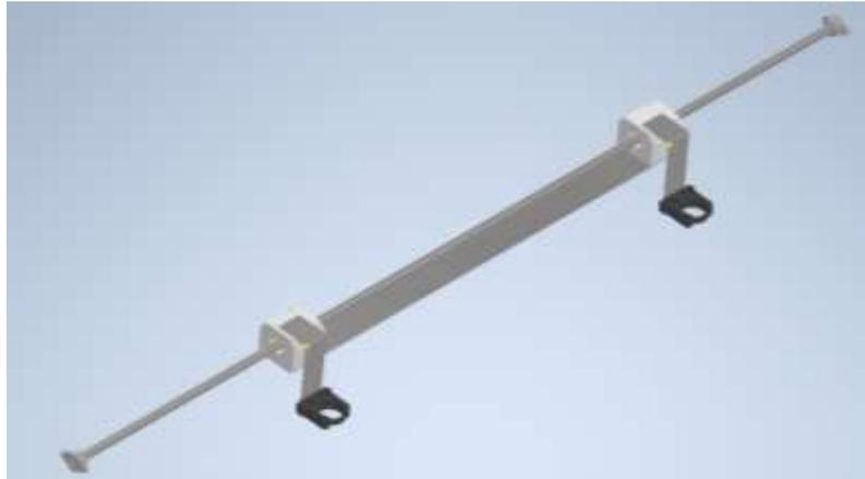
**Nota.** El palpador guía el movimiento mientras la antorcha lo replica, estos movimientos permiten cortes precisos tanto en el eje X como en el Y.
