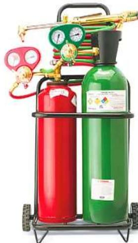
**Nota.** La figura muestra el equipo de oxicorte junto con las válvulas antirretorno, mangueras, antorchas de corte, cilindros, etc.
