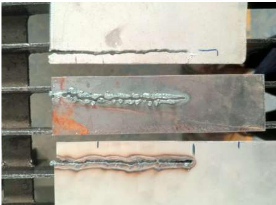
Para realizar la correcta comparación de precisión y tiempo de operación se utilizaron los mismos materiales y parámetros, con cortes rectos de 10 cm, en este caso utilizando el prototipo implementado en el laboratorio, resultados que se muestran en la tabla 22 y 23.
