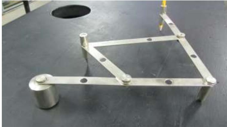
**Nota.** La figura muestra un mecanismo de cuatro barras conectadas mediante articulaciones que permiten el movimiento, su función es amplificar o replicar movimiento de manera precisa.
