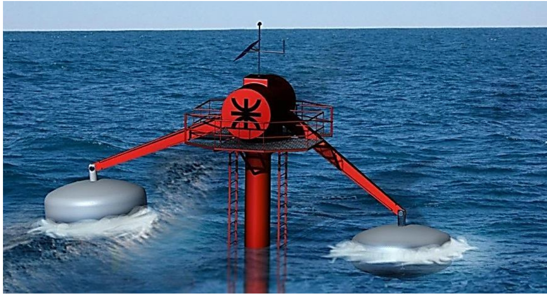
Ilustración 21. Imagen virtual convertidor undimotriz UTN.
