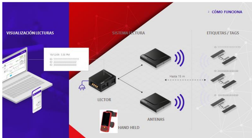
Figura 26. Diseño del Sistema Findit con la Tecnología RFID
