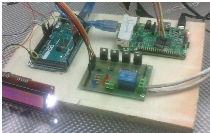
Figura 3.3: Sistema electrónico para control de actuadores.
