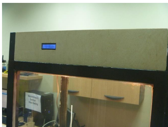
Figura 2.19: Panel superior con LCD para mostrar parámetros ambientales.
