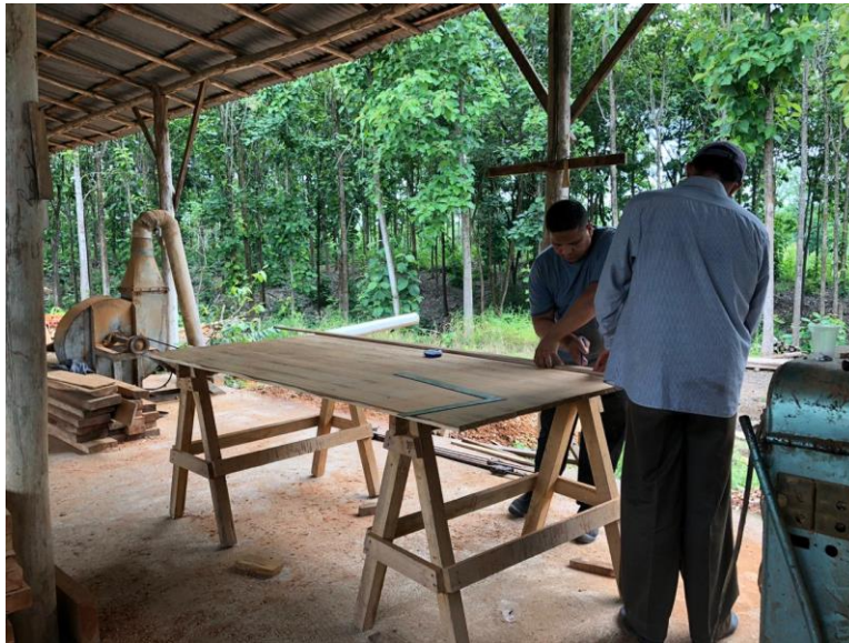
Ilustración 3-9. Corte de tablero de listones de madera con medidas requeridas Fuente: los autores
