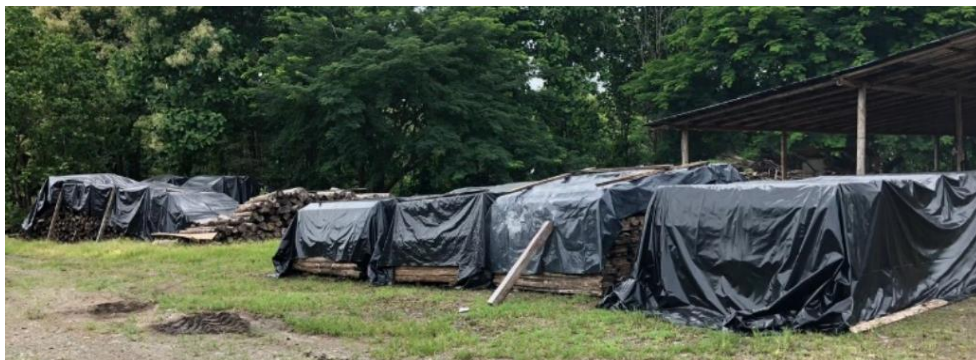
Ilustración 3-2. Compra y almacenamiento de trozas. Secado natural
