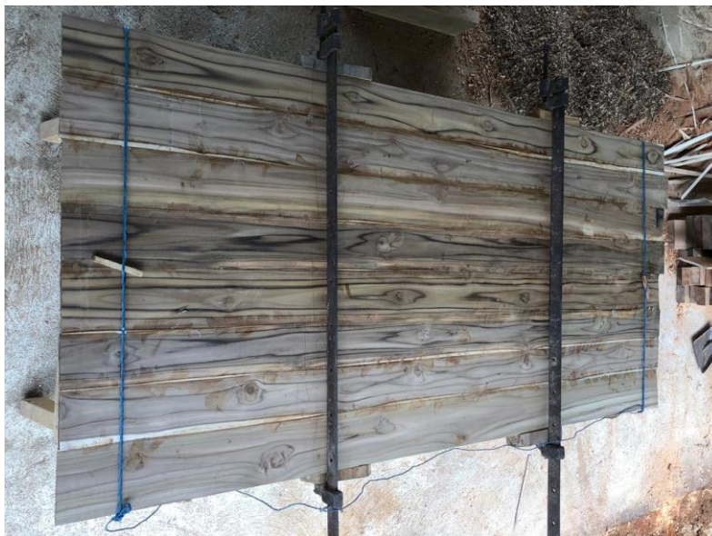
Ilustración 3-8. Prensado de listones de madera
