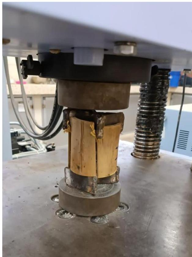
**Figura 2.19** Probeta con cruces en Máquina de Ensayo
