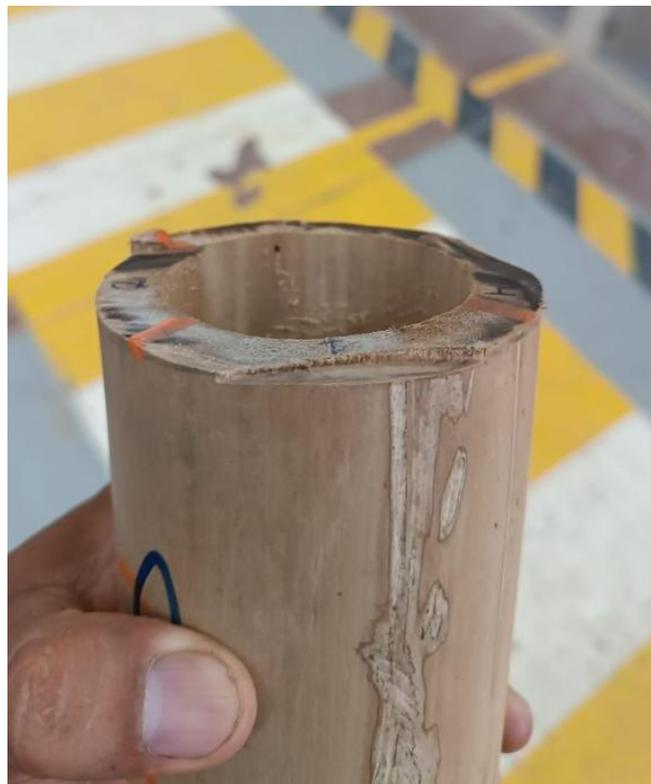
**Figura 2.17** *Probetas de Ensayo a Corte*
