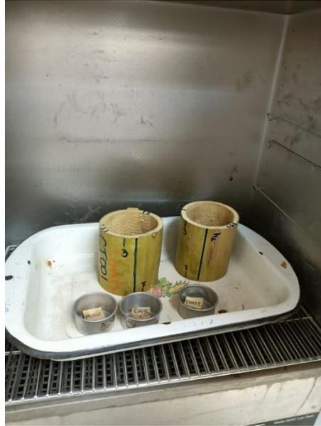
**Figura 2.20** *Probetas de contracción en horno*
