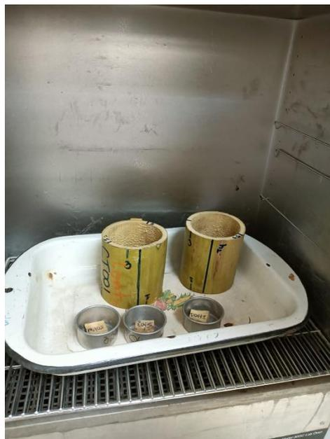
**Figura 2.21** Probetas de contenido de humedad en horno
