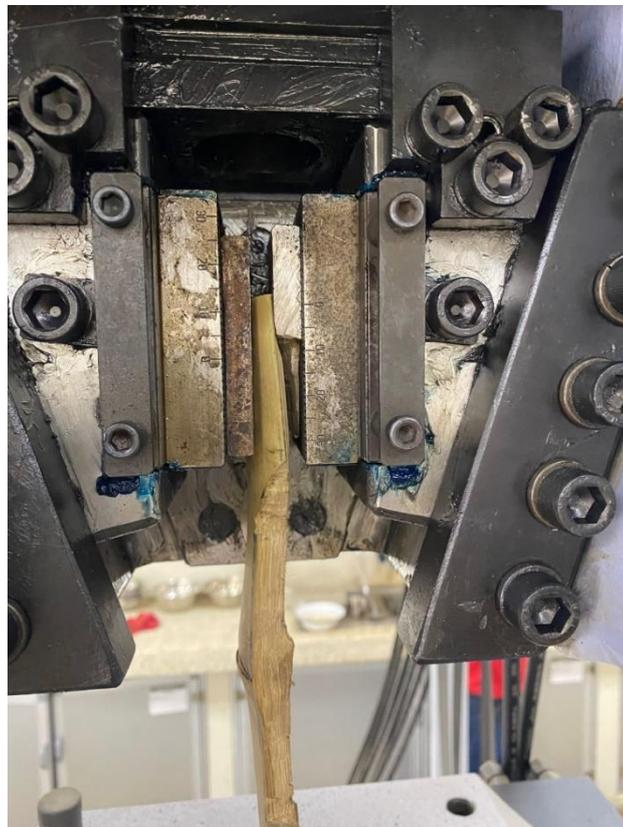
**Figura 2.16** Probeta con acoples en Máquina de Ensayo
