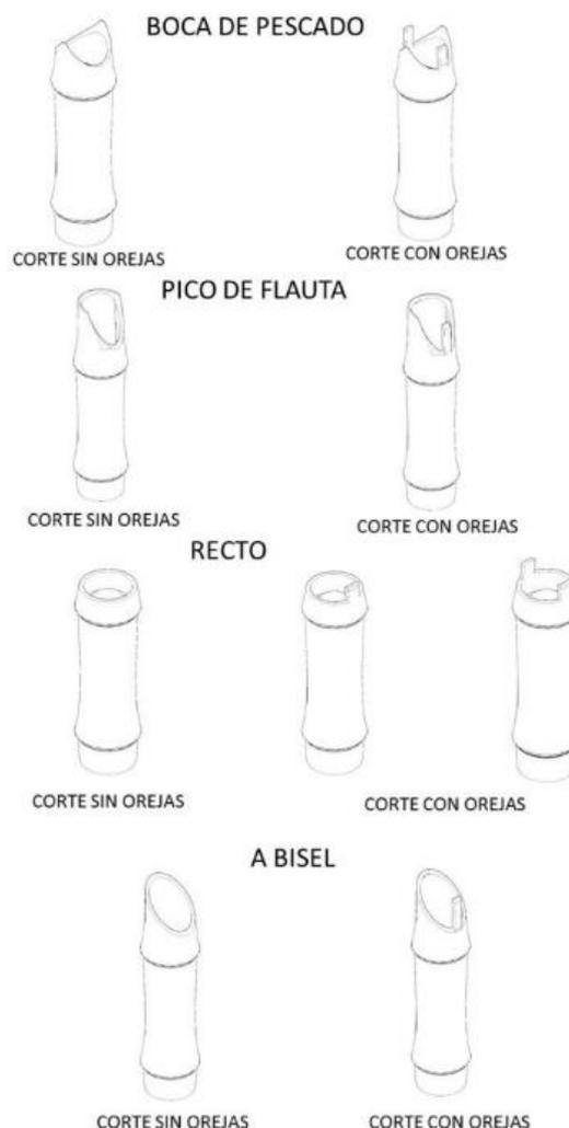
**Figura 3.14** Tipos de cortes para uniones [NEC-SE-Guadua]
