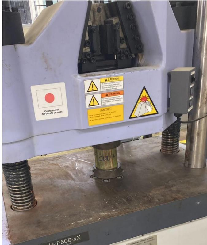
**Figura 2.13** *Probeta sometida a compresión*
