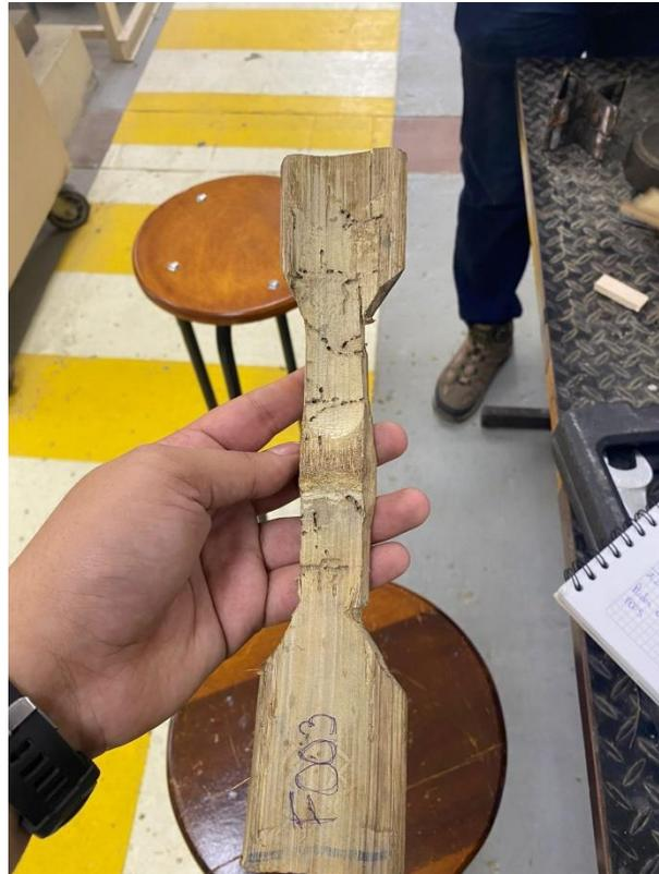
**Figura 2.14** *Probetas de Ensayo a Tensión*
