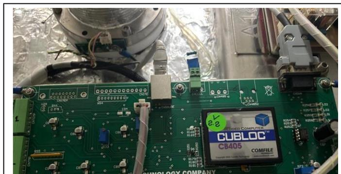
ILUSTRACIÓN 24. CONEXIÓN DE RESISTENCIA EN TARJETA DE INTERFAZ I/O.
