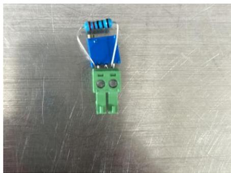
ILUSTRACIÓN 23. RESISTENCIA DE 120.10 $\Omega$ .
