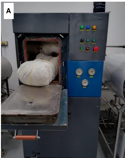
Figura 43. Finalización de esterilizado(A), Marca de cinta de control (B).
