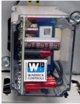
Figura 8. Control de nivel de agua
