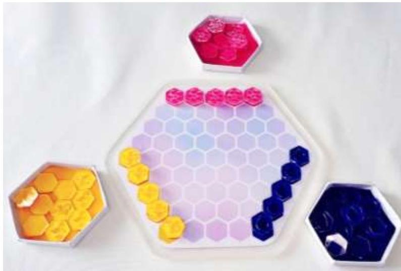
*Nota.* La imagen muestra la mejora del diseño del tablero, se decidió realizar los dos diseños de los tableros como una impresión directa en la cual todo el diseño se encuentre plasmado en una capa por versión, resultado dos capas de impresión en vinilo adhesivo en lugar de siete. Además, esto genera una mayor eficiencia al momento de la manufactura tanto en costos, materiales y ensamblaje.
