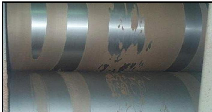
**FIGURA 3.10 RODILLO CON PRESENCIA DE MASA ADHERIDA**
