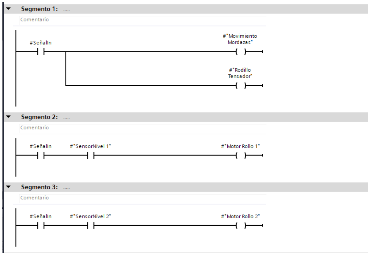
Figura B.1. Programación del bloque activación motores
