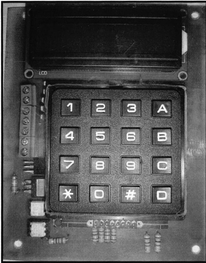
*Figura 30. Tarjeta para control de la cerradura*
