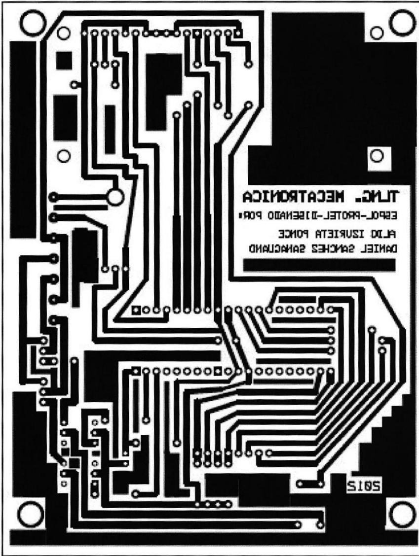
Figura 29. Circuito Impreso para el control de la cerradura
