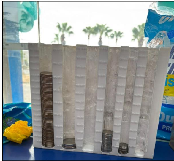
Figura 50: Prototipo de poka-yoke para conteo y clasificación de monedas
