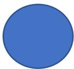
**Operación:** se efectúa un cambio o transformación en algún componente del producto, ya sea por medios físicos, mecánicos, químicos o la combinación por cualquiera de los tres.
