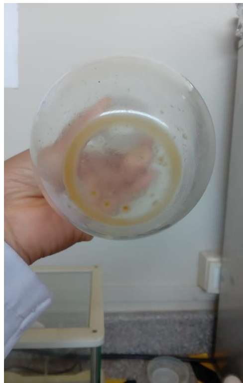
Acumulación de la grasa en el fondo del balón luego del secado en la estufa
