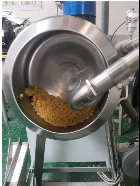
Secado del producto extruido en el secador de tambor
