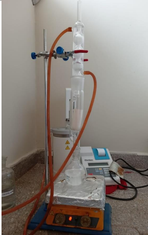
Montaje del sistema de extracción Soxhlet
