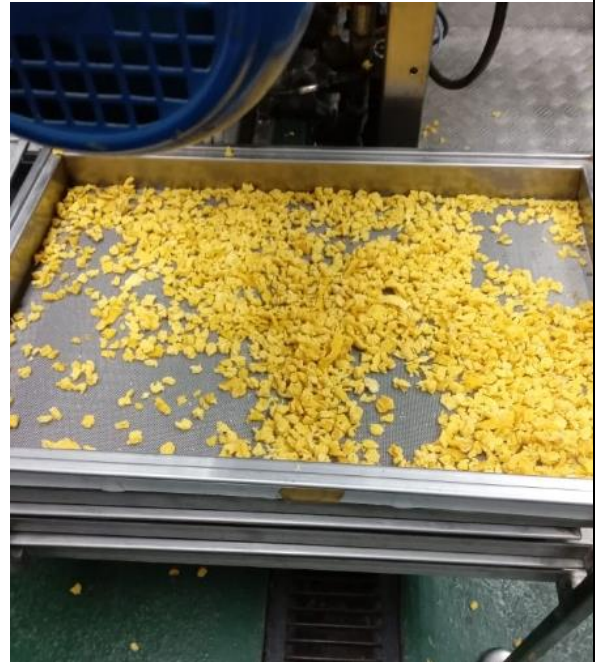
Secado del producto extruido en el secador de tambor
