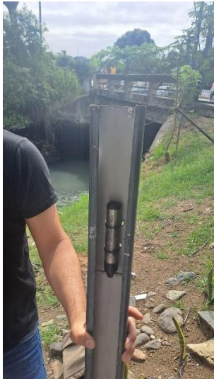
a. Sensor de presión plantado en cada estación
