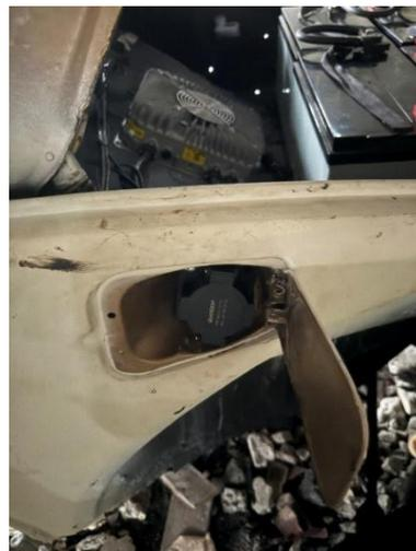
Sección delantera del vehículo con set de 4 baterías y modulo del cargador
