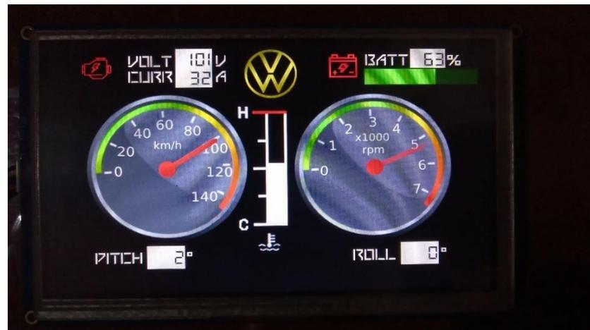
Se diseñó un dashboard que se puede visualizar en la figura 62, con ayuda de un HMI marca Nextion de 7 pulgadas, un tamaño adecuado para visualizar los parámetros más importantes del vehículo. El sistema permite supervisar las siguientes variables:
