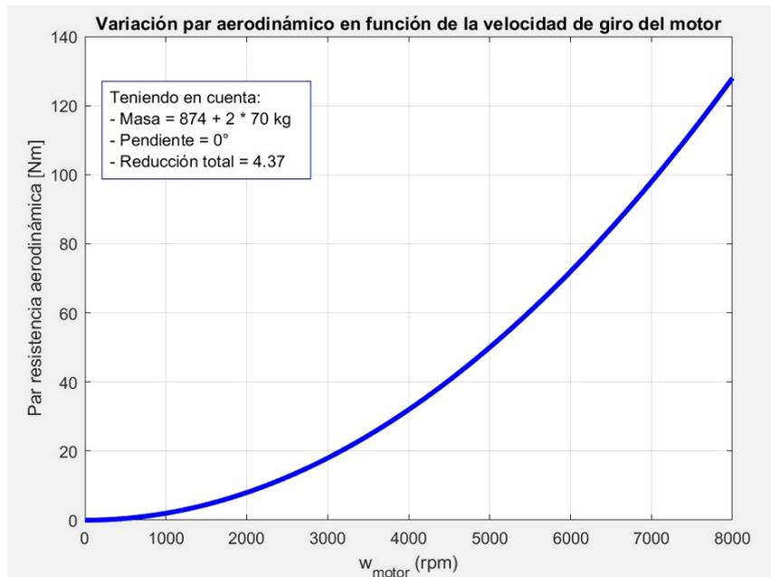
En la figura 30, la variación de la velocidad de giro del motor debido a la resistencia aerodinámica se explica mediante la fórmula de la fuerza aerodinámica, la cual incluye una componente cuadrática. Este comportamiento se refleja en la gráfica, mostrando que, al aumentar la velocidad del vehículo, se requiere un mayor torque [Nm] para mover el vehículo y superar la resistencia que el viento ejerce sobre él.
