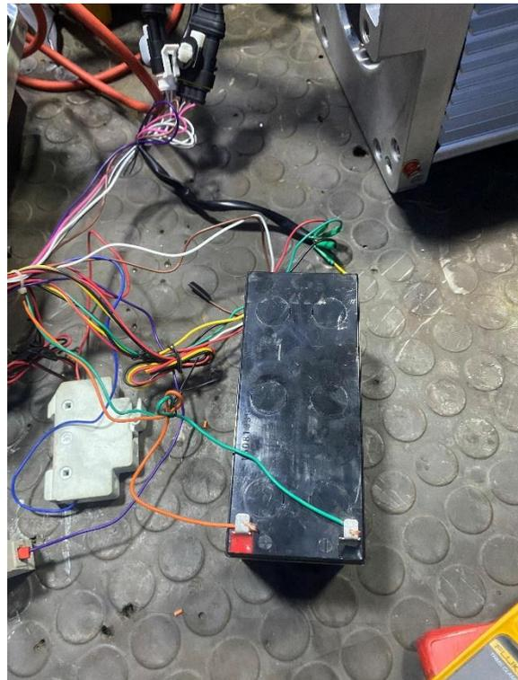
En esta sección se realizó la conexión del motor trifásico en vacío a la controladora que a su vez esta alimentada por las baterías de gel y se realizó varias simulaciones de arranque y frenado con el uso del pedal y freno electrónicos. En donde con el uso de una pinza amperimétrica FLUKE se obtuvo como resultado las siguientes graficas con diferentes situaciones para analizar el comportamiento de la corriente y voltaje tanto del motor como de las baterías.
