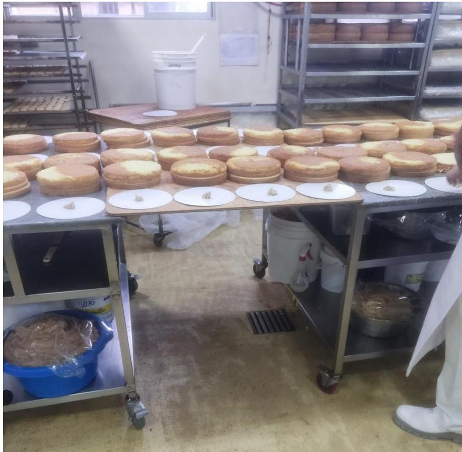
En este caso utilizan un tablón de madera para unir dos mesas y extender la superficie de trabajo, pero hacerlo de esta manera resulta arriesgado debido a que no posee ningún elemento de anclaje o sujeción y puede deslizarse fácilmente con un empujón.
