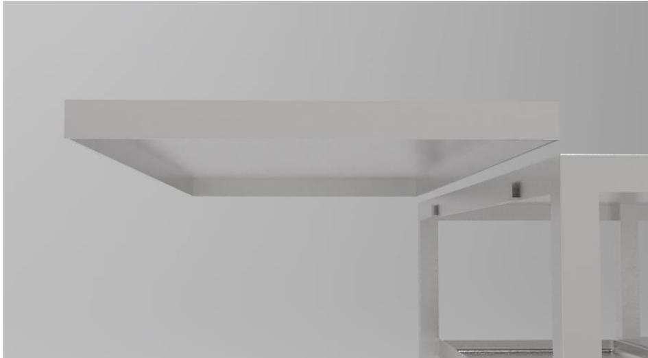
Debido a que no se utilizó un mecanismo que regula la altura de la superficie de trabajo, en la parte inferior de la mesa se incorporaron 4 bloques de acero que funcionan como cajones para que los usuarios de menor estatura puedan pararse sobre ellos y de esta manera estar a una altura adecuada para realizar sus actividades. Estos cajones se pueden extraer y devolver a su posición inicial cuando sea necesario.
