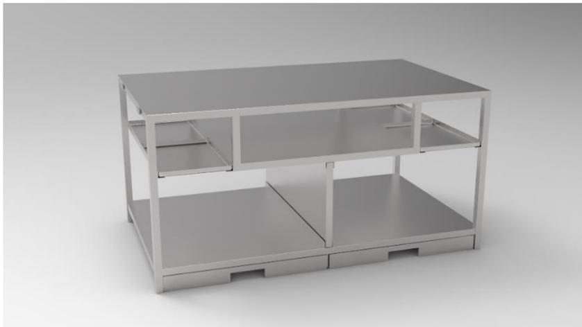
De esta manera se realiza el diseño digital de una mesa con una superficie principal para las actividades de panadería y dos superficies de apoyo o repisas que funcionan como almacenamiento. En la primera se incluyen 4 bandejas extraíbles en las cuales se colocan los elementos y utensilios de uso frecuente para que los usuarios puedan acceder fácilmente a ellos.
