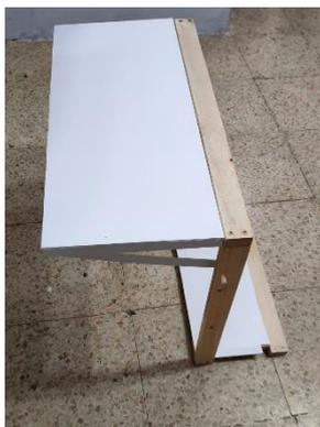
Como se puede observar en la imagen, el mecanismo funciona correctamente al sujetar la pieza rectangular con firmeza e impidiendo que las planchas laterales que la sostienen se deslicen hacia abajo. Esto es posible gracias a las dimensiones y forma que tienen dichas planchas como se muestra a continuación:
