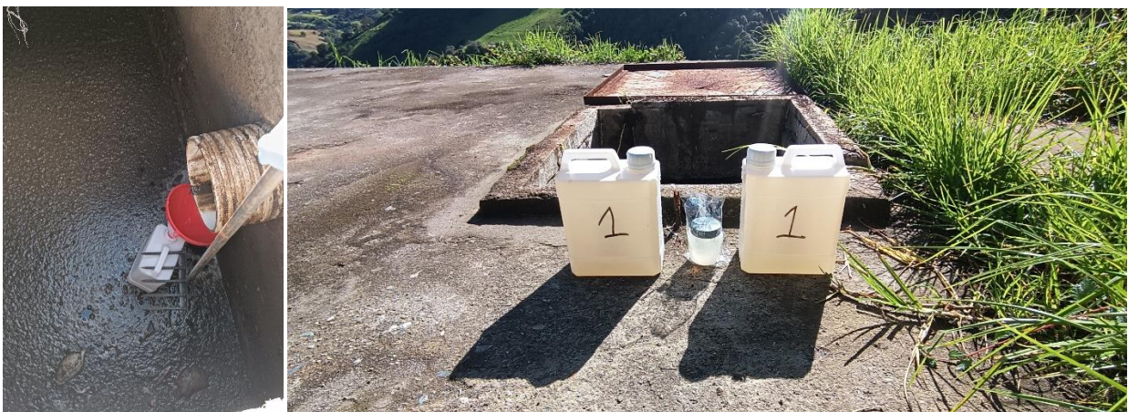
Figura 19. Toma de muestras de agua en la entrada a la PTAR.
