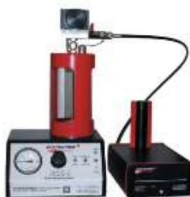
Figura 5.12 Contador de partículas
