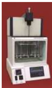
Figura 5.9 Medidor de demulsibilidad
