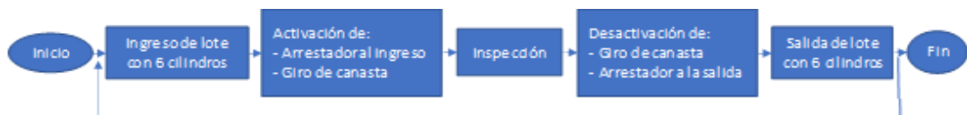
Figura 2.4 Algoritmo para proceso de prueba de estanquidad
