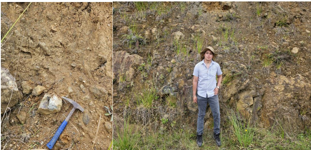
Figura 25. Material coluvial presente en el macro deslizamiento Llamacón
