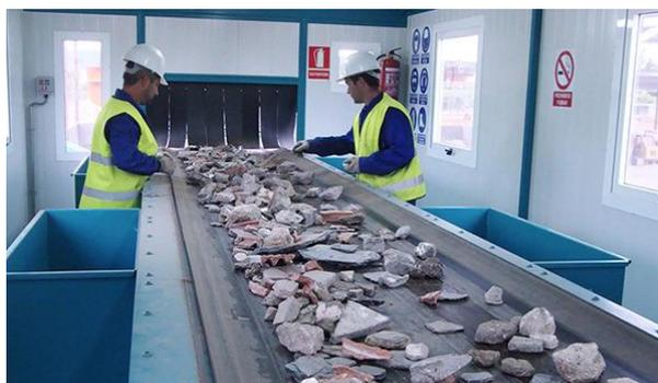
**Figura 3.4.-** Separación manual de los RCD
