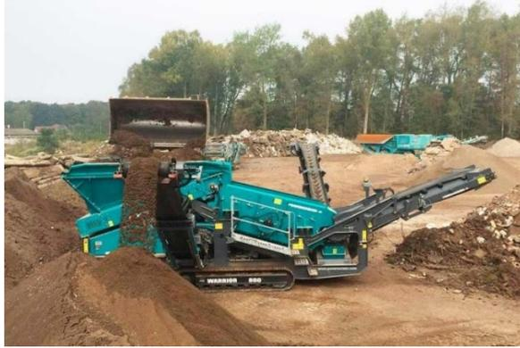
**Figura 3.5.-** Cribado y tamizado de los RCD
