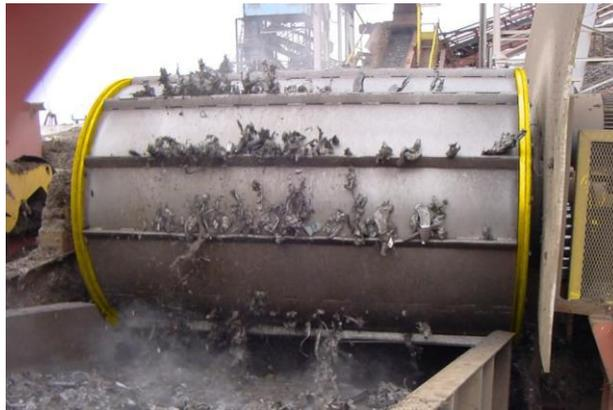
**Figura 3.6.-** Separación magnética de los RCD
