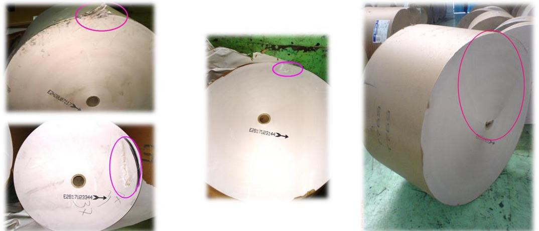
**Figura 1.1** Papel defectuoso generado por exceso de manipulación
