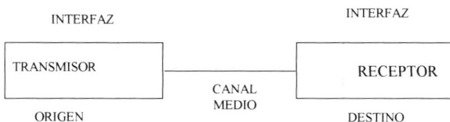
Figura 2.1 Canal de comunicación de datos típico
