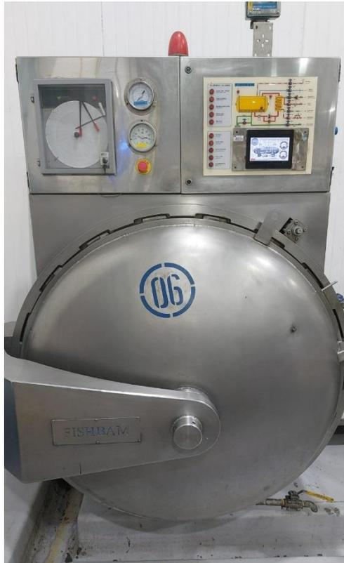
Figura 1.7 Autoclave utilizado para la esterilización.
