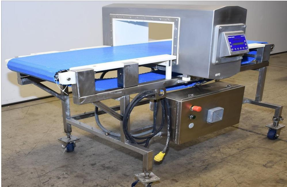
**Figura 1.6 Detector de metales utilizado en la planta.**
