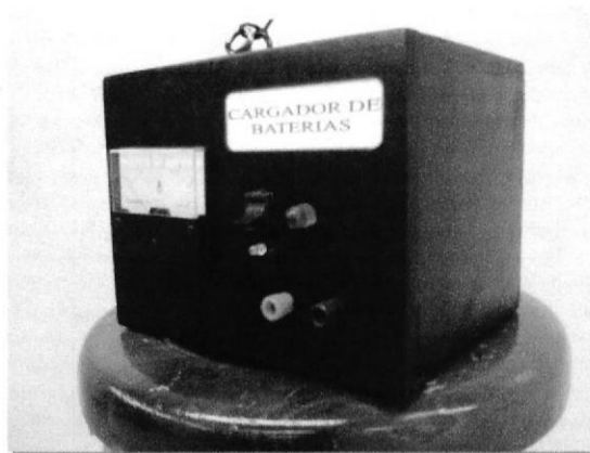
Cargador de baterías Instalado FIG. 27
