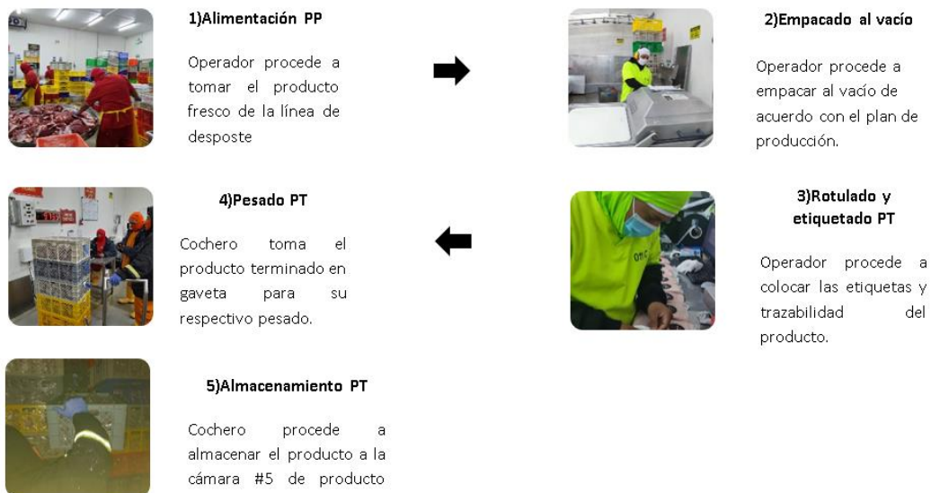
Figura 0.9 Flujograma de la línea de empackado al vacío
