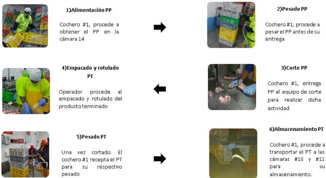
Figura 0.5 Flujograma gráfico de la línea de corte de congelados
