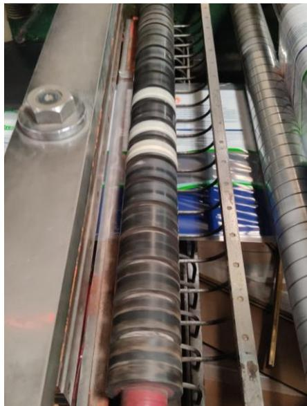
El primer par de rodillos que se encuentra en la mesa tensora se posicionan como se muestra en la Figura 2.15.
