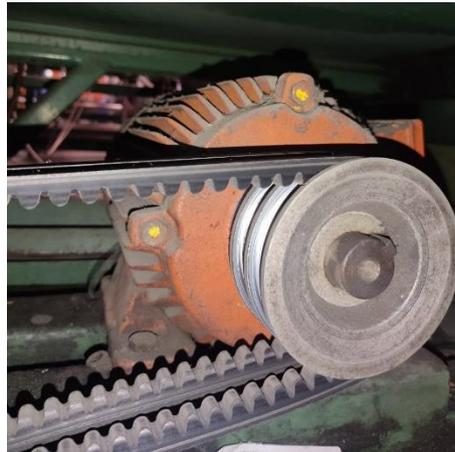
**Figura 2.7***Reductor de velocidad del sistema de avance y corte*
