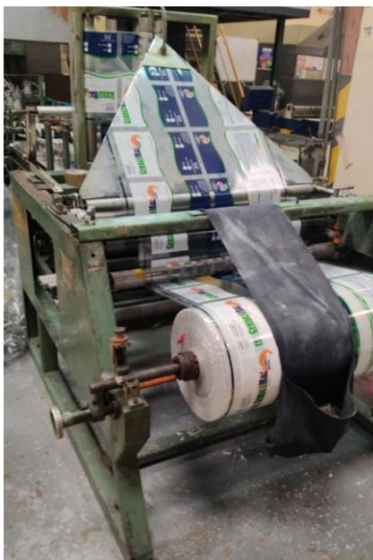
Esta selladora consiste en una estructura con un motor CA principal que, mediante un sistema mecánico de levas, piñones, rodillos y cadenas, permite avanzar el rollo de plástico, sellar y cortar las fundas. También cuenta con un motor CC secundario encargado del movimiento de un balancín, que permite tensar y aflojar el rollo de fundas.
