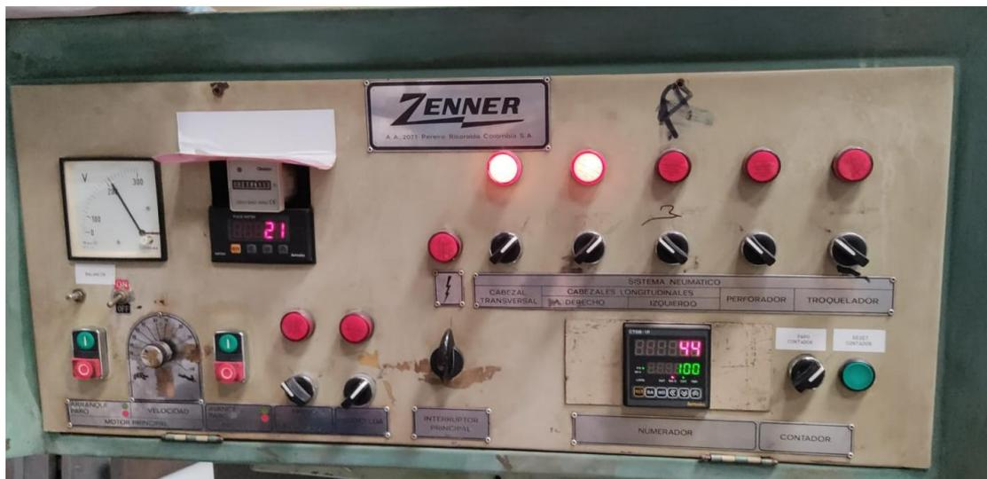
Se decide mantener los paneles de control de temperatura y de presiones neumáticas tal y como se encuentran actualmente, sin embargo, se considera que el panel general necesita una renovación, de forma que el operador pueda modificar parámetros a través de una pantalla y se deje atrás el uso de perillas y botoneras.
