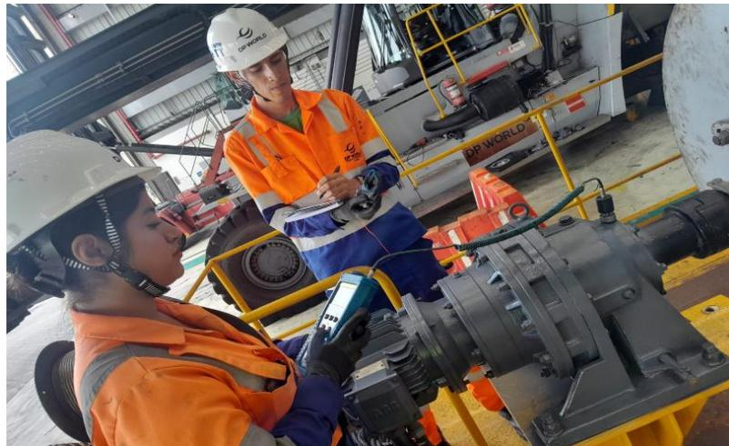
*Nota.* Una vez cargada la ruta se procedió a realizar el análisis a los rodamientos del reductores, en los puntos específicos.
