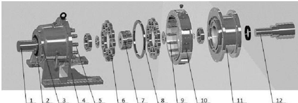
*Nota.* Partes del reductor cicloidal, imagen obtenida de la ficha técnica Guomao Reducer.
