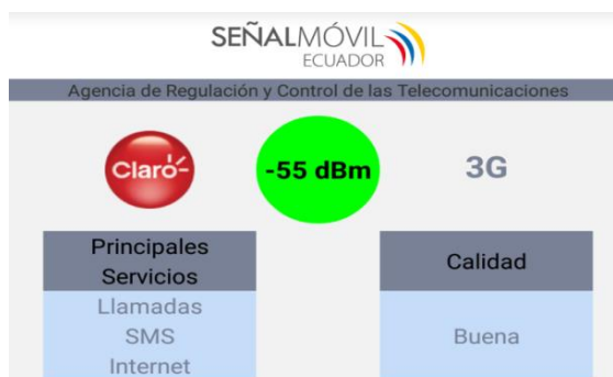
Figura 3.37 Cobertura 3G en la Primera Sirena electrónica
