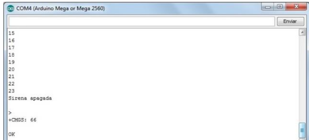
Figura 4.19 Luego del conteo para comparar se desactiva la sirena
