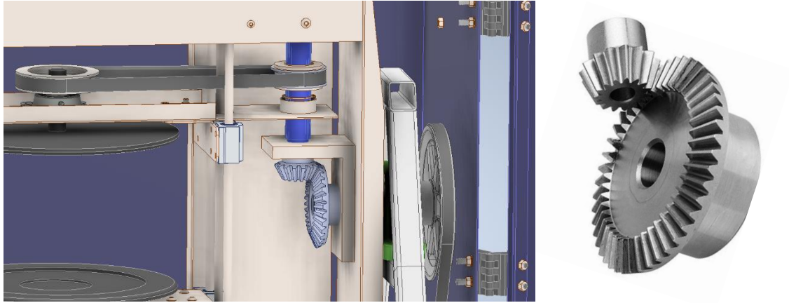
Figura 24. Transmisión de la potencia por engranes cónicos
