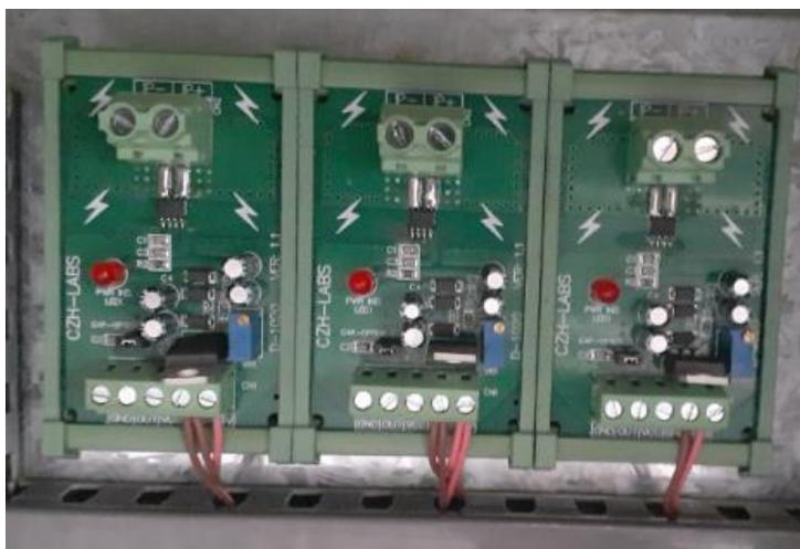
En la Figura 2.4 y 2.5 se muestran los insertos para el microcontrolador y los sensores de voltaje y corriente.
