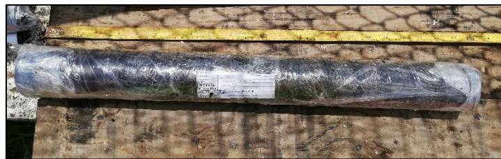
Figura 4.2 Toma de muestra con tubo Shelby y su respectiva identificación.
