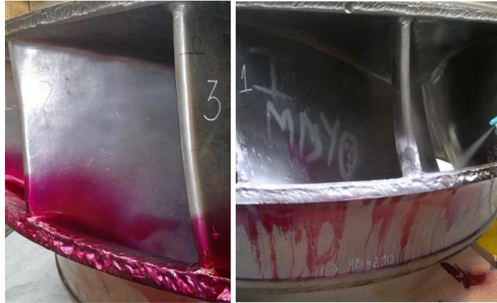
**Figura 4.14 Aplicación de líquidos penetrantes**
