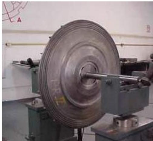
**Figura 4.9 Modelo de Sistema de Balanceamiento estático**
