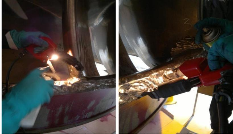
**Figura 4.16 Inspección por partículas magnéticas**
