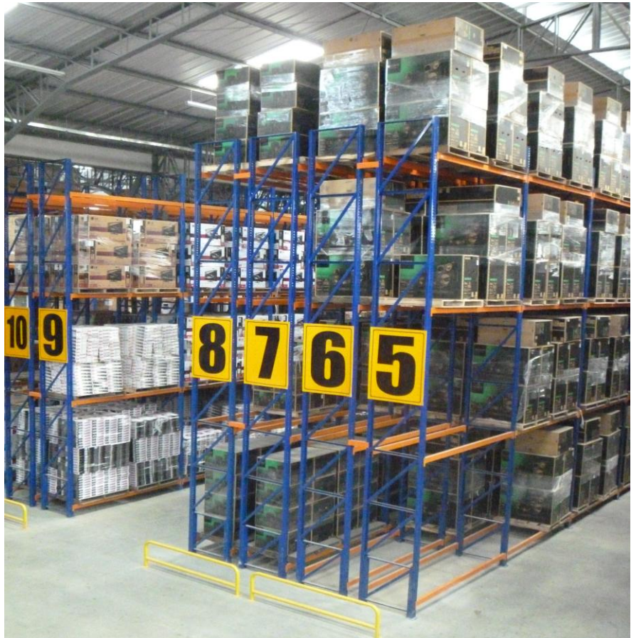
Figura 4.11 Vista real de racks selectivos doble profundidad construidos en CEDI.
