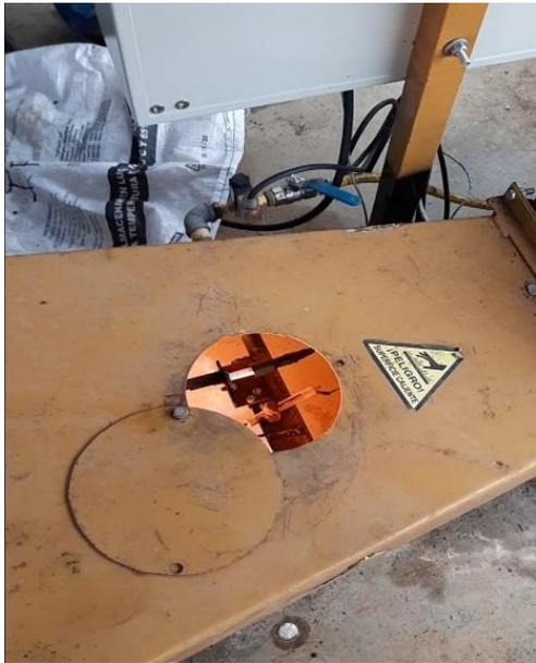
*Nota:* Quemador fabricado de forma artesanal utilizado en secador actual.
