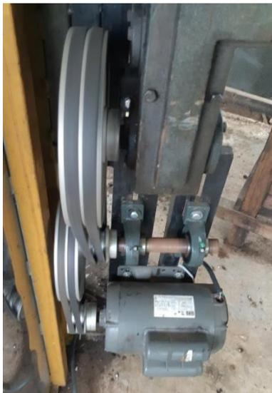
*Nota.* Sistema de transmisión con un tren de chumaceras y un conjunto de poleas antes de la entrada del reductor.
