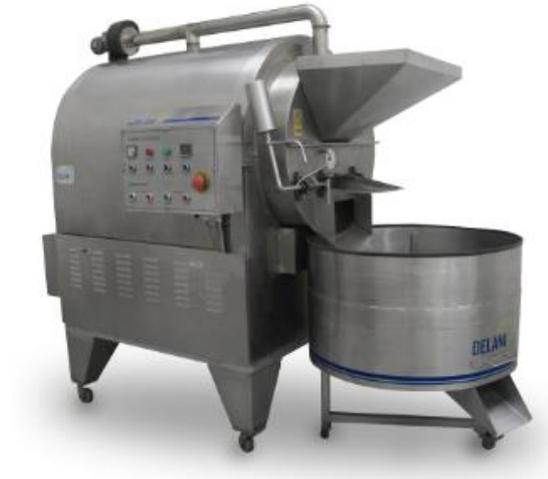
*Nota.* En la figura se observa un tostador discontinuo con tambor rotatorio interno. (Delani, 2019)
