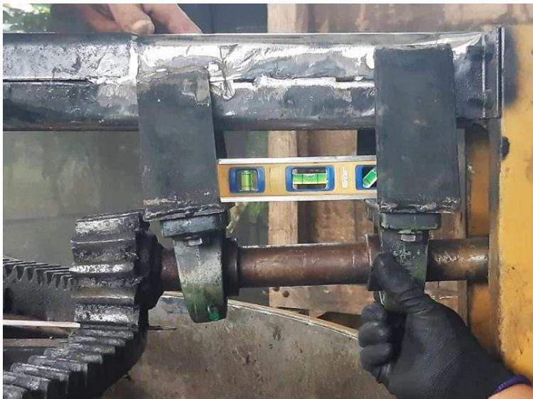
**Figura 63***Ajuste de pletinas en los piñones*
