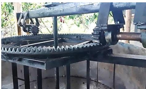
*Nota.* Se observa interferencia al momento de recubrir superiormente el tanque por su mecanismo de transmisión.
