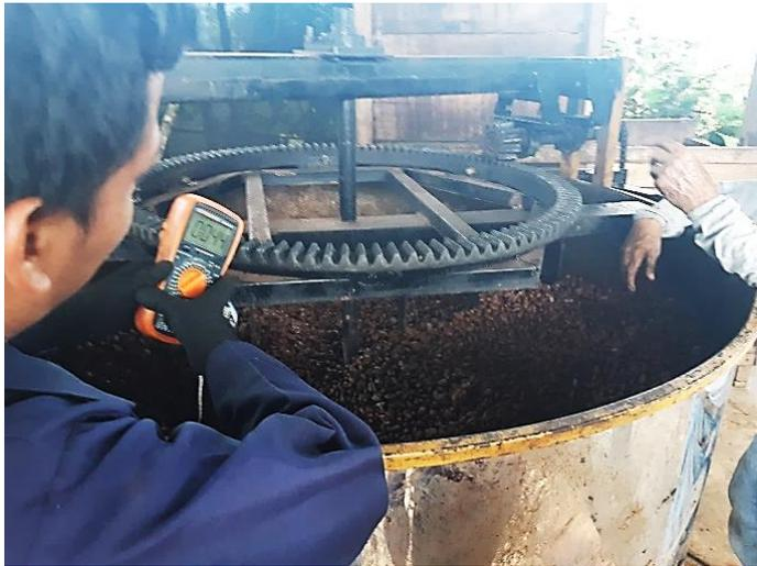
Se observa la corriente que demanda el motor en un amperímetro de garra, en este caso tiene una conexión de 220V con una corriente máxima de 11,7 A según la placa del motor.
