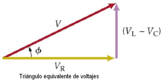
Entre los puntos A y B el estudiante mediría ( $V_L - V_C$ ) que, de acuerdo al triángulo de voltajes, sería:
