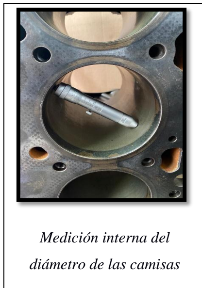
Figura 2.11 Medición de camisas
