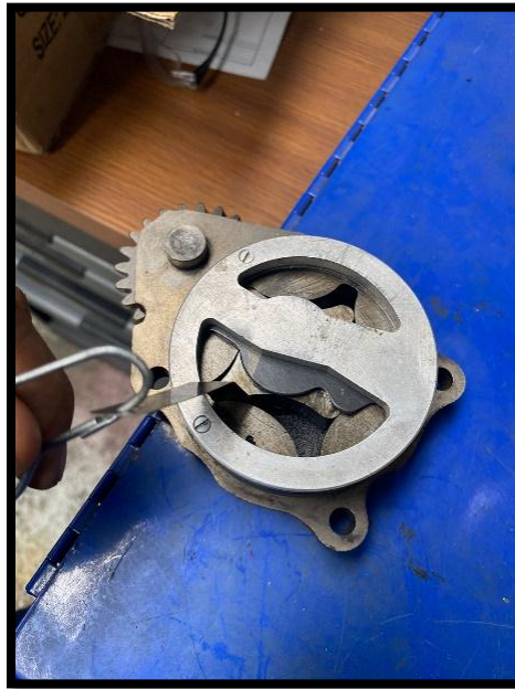
Figura 2.16 Medición del juego de ápices de los resaltos de corona y del rotor
