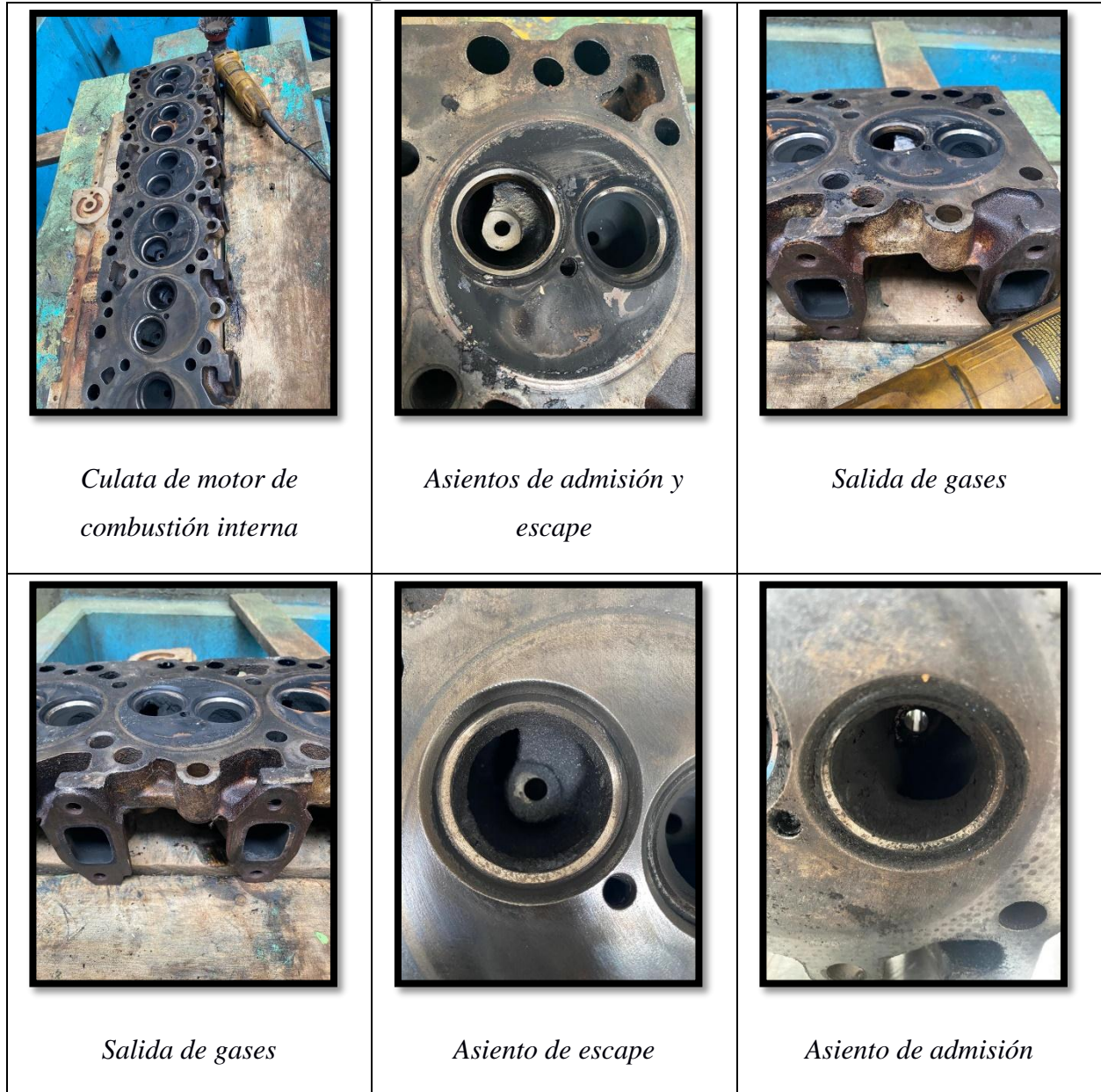
Figura 2.10 Revisión del estado de la culata
