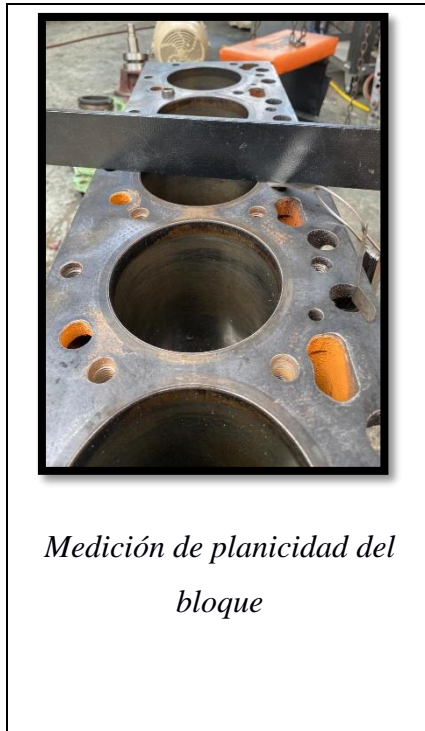
Figura 2.9 Medición de planicidad transversal y vertical del bloque del motor
