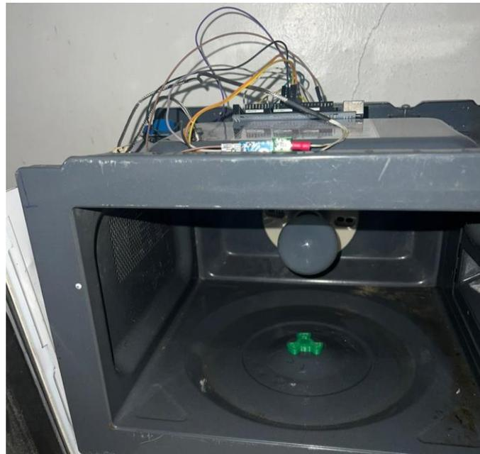
En la *Figura 3.24* se demuestra el sistema controlado de temperatura para la prueba de concepto en donde se utilizó el código generado en Arduino IDE adjunto en el *Apéndice D*. El control de temperatura de prueba se realizó con un rango de histéresis de  $\pm 2$  grados celsius y con un set point de temperatura de  $30^{\circ}$  grados celsius.
