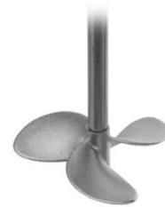
Produce movimientos radiales y tangenciales que forman un vórtice, además de que las hojas pueden tener una variedad de formas (rectas, curvas, inclinadas), lo que permite un funcionamiento eficiente en una amplia gama de velocidades.
