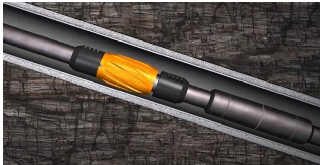
Figura 6: Baja fricción entre la tubería y el casing
