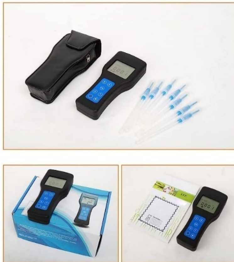
Figura 3.1. Luminómetro GOYOJO (Amazon.com, 2024)
