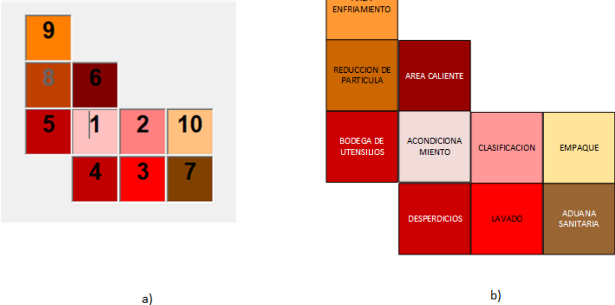
Figura 3.3 a) Resultados Software CORELAP b) Layout especificado por etapas [Fuente: Elaboración Propia]
